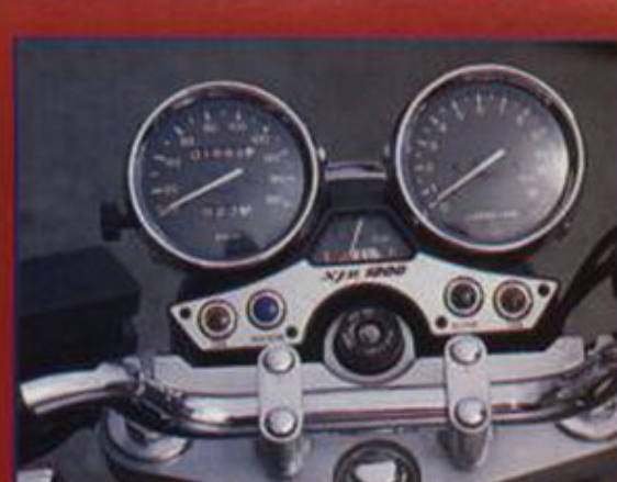
Zeer fraaie, klassieke tellers met een handige benzine-meter. In de toerenteller zit een olielampje geïntegreerd.
