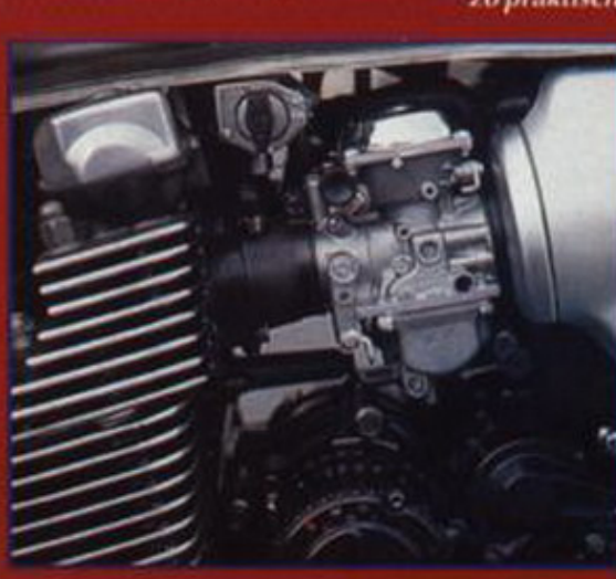
De chokeknop zit op de linker carburateur: niet zo praktisch.
